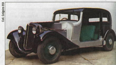
◀ Le prototype de la carcasse coulé en alpac, montée sur une Adler Trumpf Junior en 1934.
